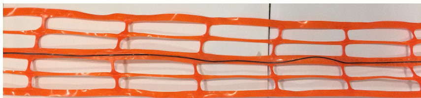
Markeringsnät med söktråd som skarvas i mot en KUP
